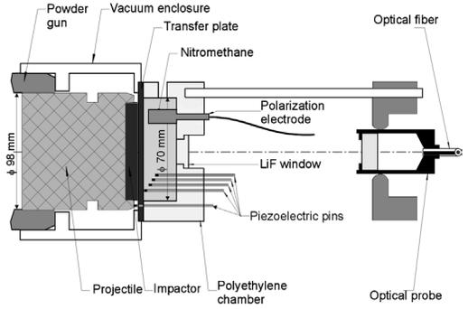
Fig. 2. Detonation target.
