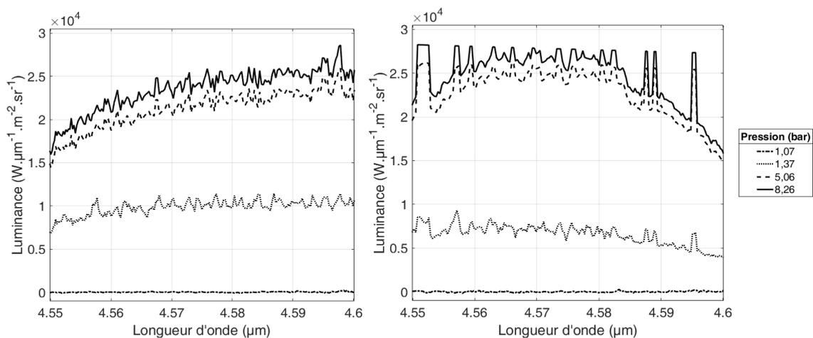
Figure 3 : Evolution du spectre du CO centré à  $4,567 \mu\text{m}$  pour le mélange 1. A gauche, étalonnage au moyen d'un corps noir, à droite étalonnage au moyen de la luminance simulée.
