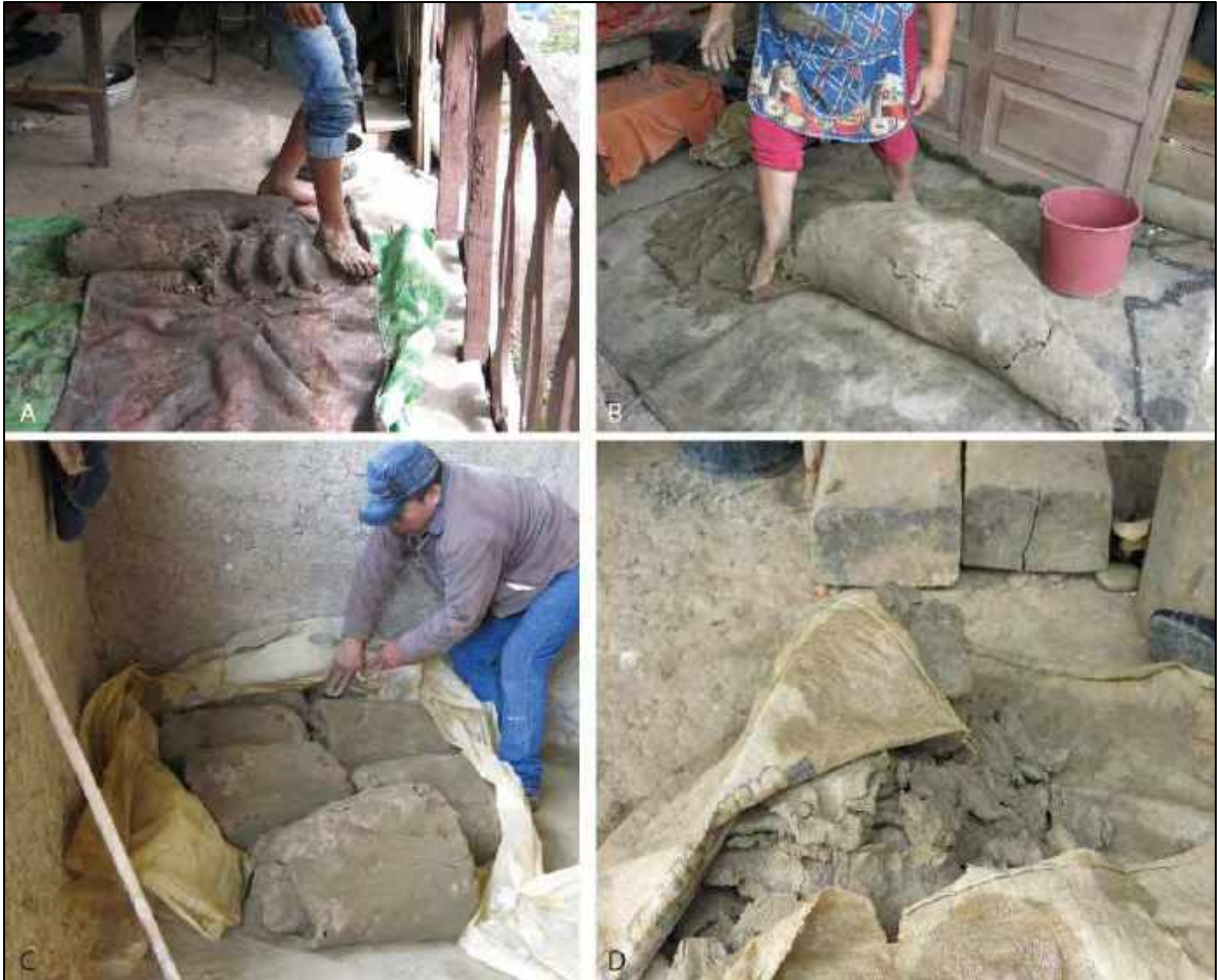
Fig. 4.16 : HOMOGENÉISATION DE LA PÂTE 2. A (Sígsig), B (Taquil) : Piétinement de la pâte « enroulée ». C (Sígsig), D (Taquil) : Entreposage de la pâte après pétrissage.
