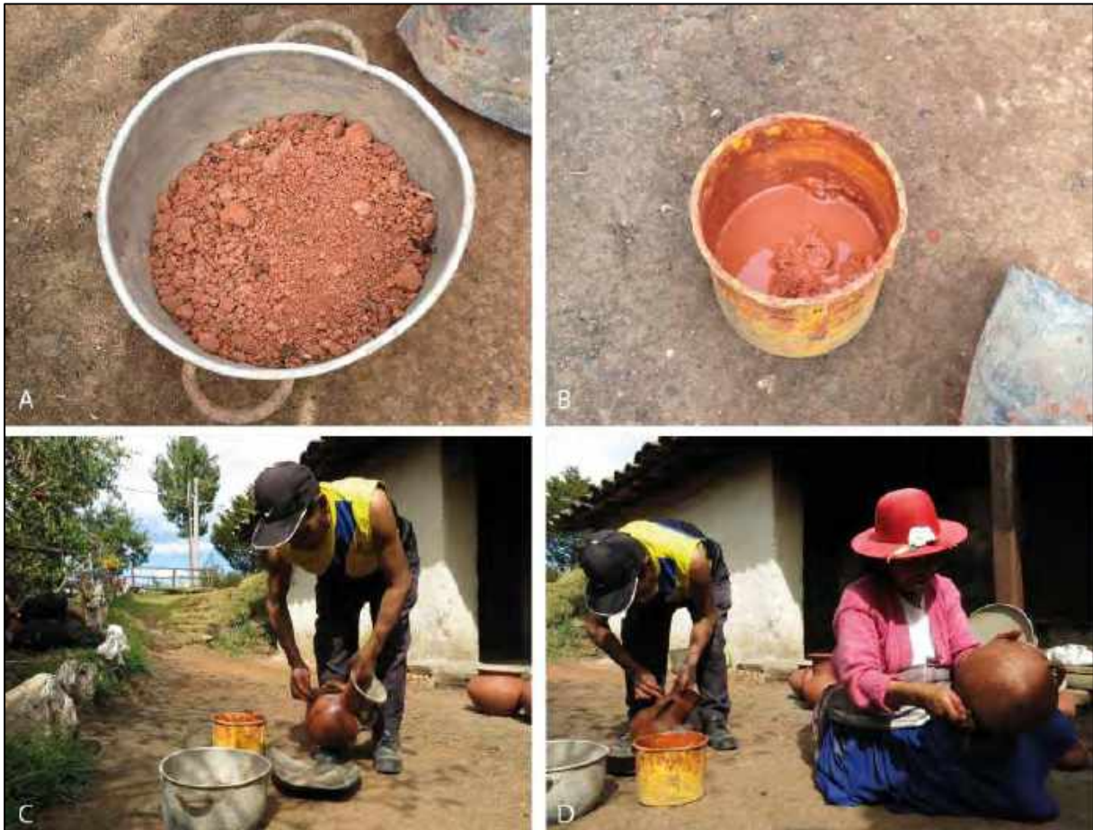
Fig. 4.31 : ENGOBAGE. A : Terre rougeâtre utilisée dans la fabrication de l'engobe. B : Rajout d'eau en vue de la préparation de l'engobe. C, D : Engobage au chiffon (Sígsig).
