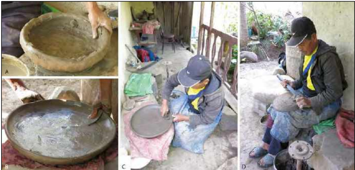
Fig. 4.27 : FAÇONNAGE DES PLATS À TORTILLAS (formes de type B). A : Aspect de l'ébauche après le creusement de la motte d'argile. B : Abaissement des parois par pressions externes (bords). C : Raclage du fond. D : Rabotage de l'assise.
