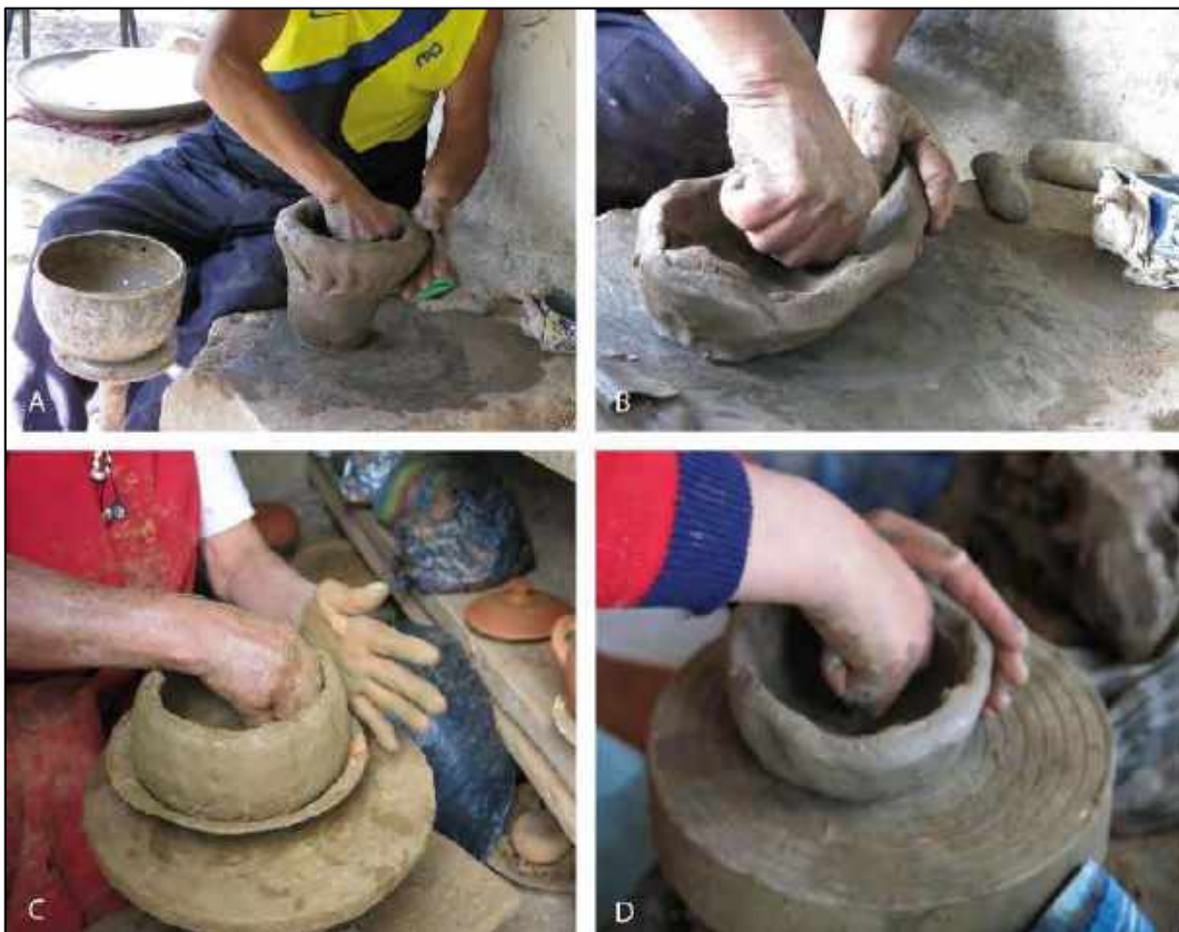
Fig. 4.19 : CREUSEMENT DE LA BOULE D'ARGILE. A, B : Sígsig. C, D : Taquil.
