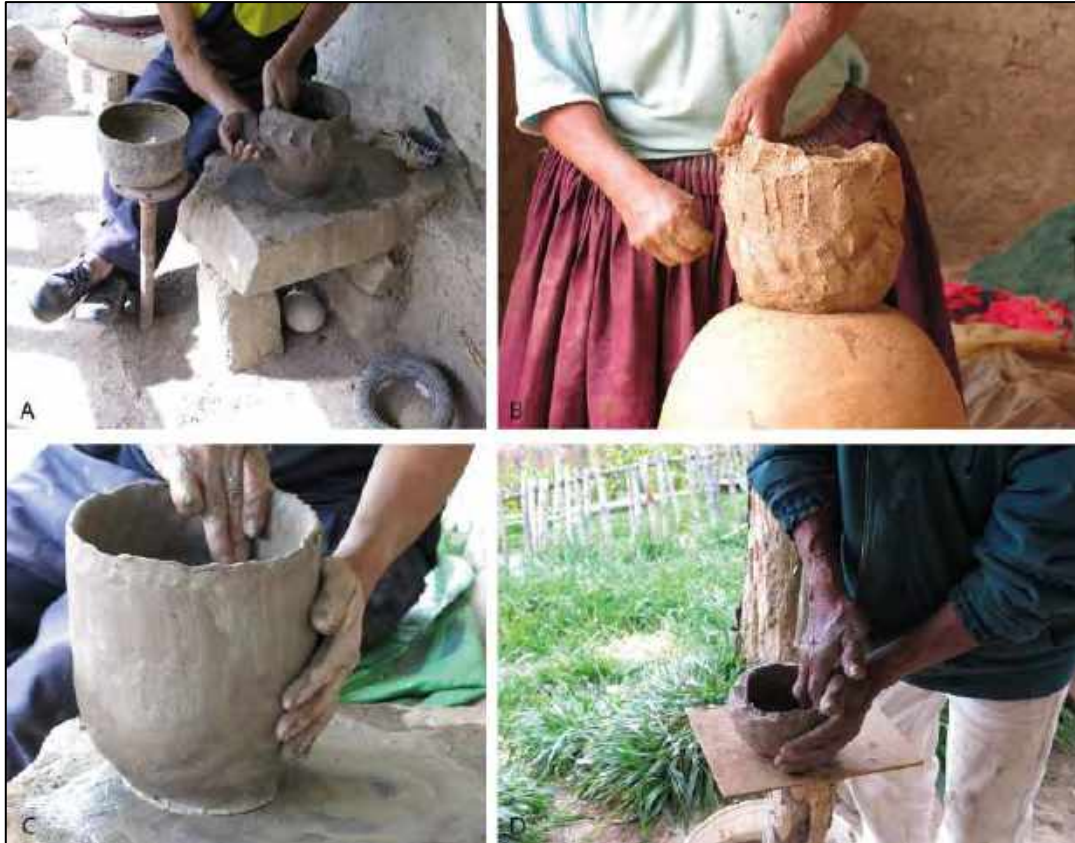
Fig. 4.20 : ÉTIREMENT / AMINCISSEMENT DES PAROIS. A (Sígisig), B (San Miguel) : Parois externes. C (Sígisig), D (San Miguel) : Parois internes.
