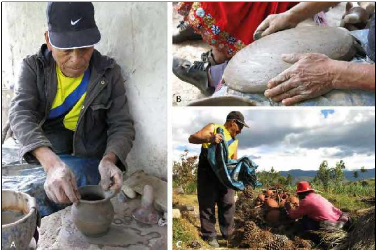
Fig. 4.40 : AUTRES PARTICULARITÉS TECHNIQUES DE LA POTERIE DE SÍGSIG. A : Mise en forme de l'assise. B : Doucissage. C : Rajout de pommes de pin au tas de cuisson.
