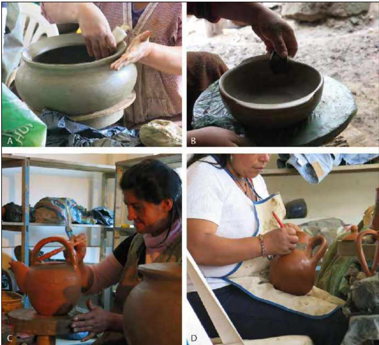
Fig. 4.44 : FINITIONS ET TRAITEMENTS DE SURFACE À TAQUIL. A : Lissage sur humide au mate. B : Lissage sur cuir à la lanière en cuir. C : Engobage au pinceau. D : Graphitage.
