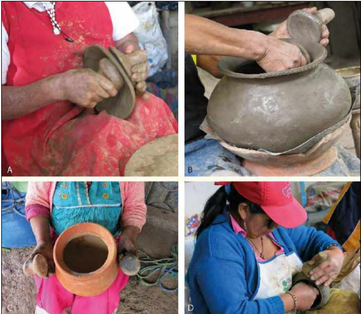
Fig. 4.22 : BATTAGE. A : Taquil. B : Sígsig (battage dans un moule). C : San Miguel. D : Taquil.
