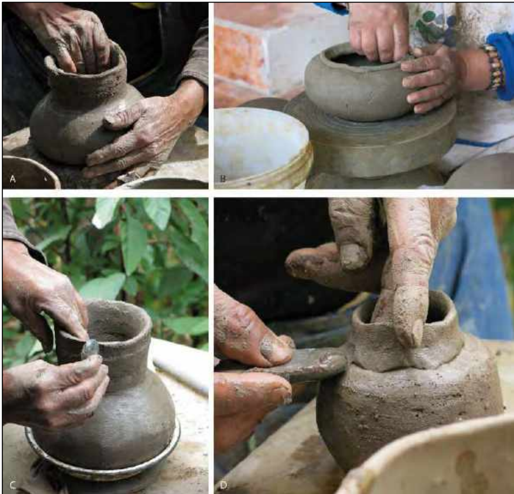
Fig. 4.26 : COLOMBINAGE. A (Sígsig), B (Taquil) : Pose du colombin par écrasement. C, D (Sígsig) : Jointure des colombrins.
