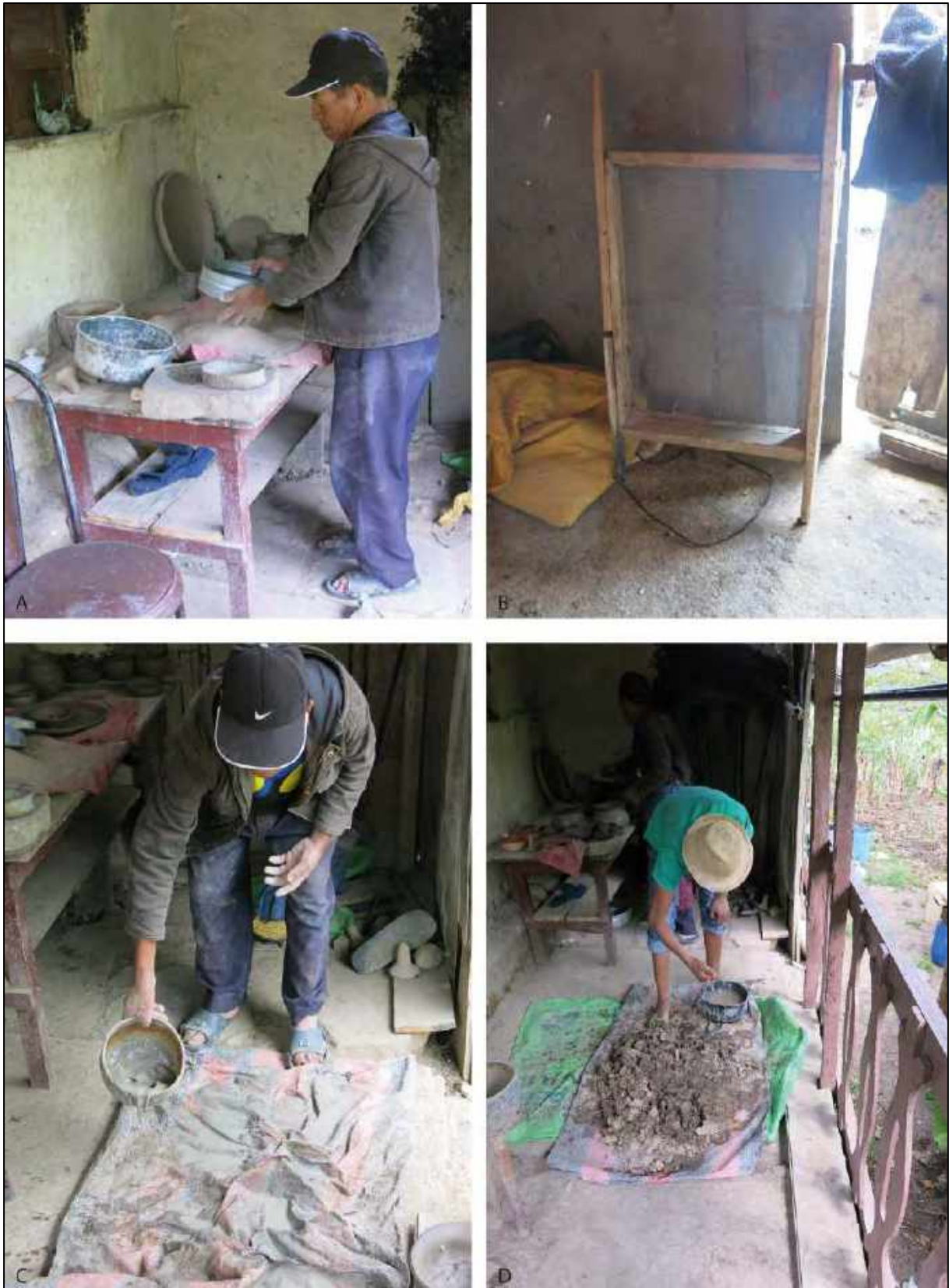
Fig. 4.14 : PRÉPARATION DE LA PÂTE 2. A : Tri granulométrique du dégraissant (passoire- Sígsig). B : Tri granulométrique du dégraissant (feuille de métal - San Miguel). C, D : Hydratation par humectation (Sígsig).
