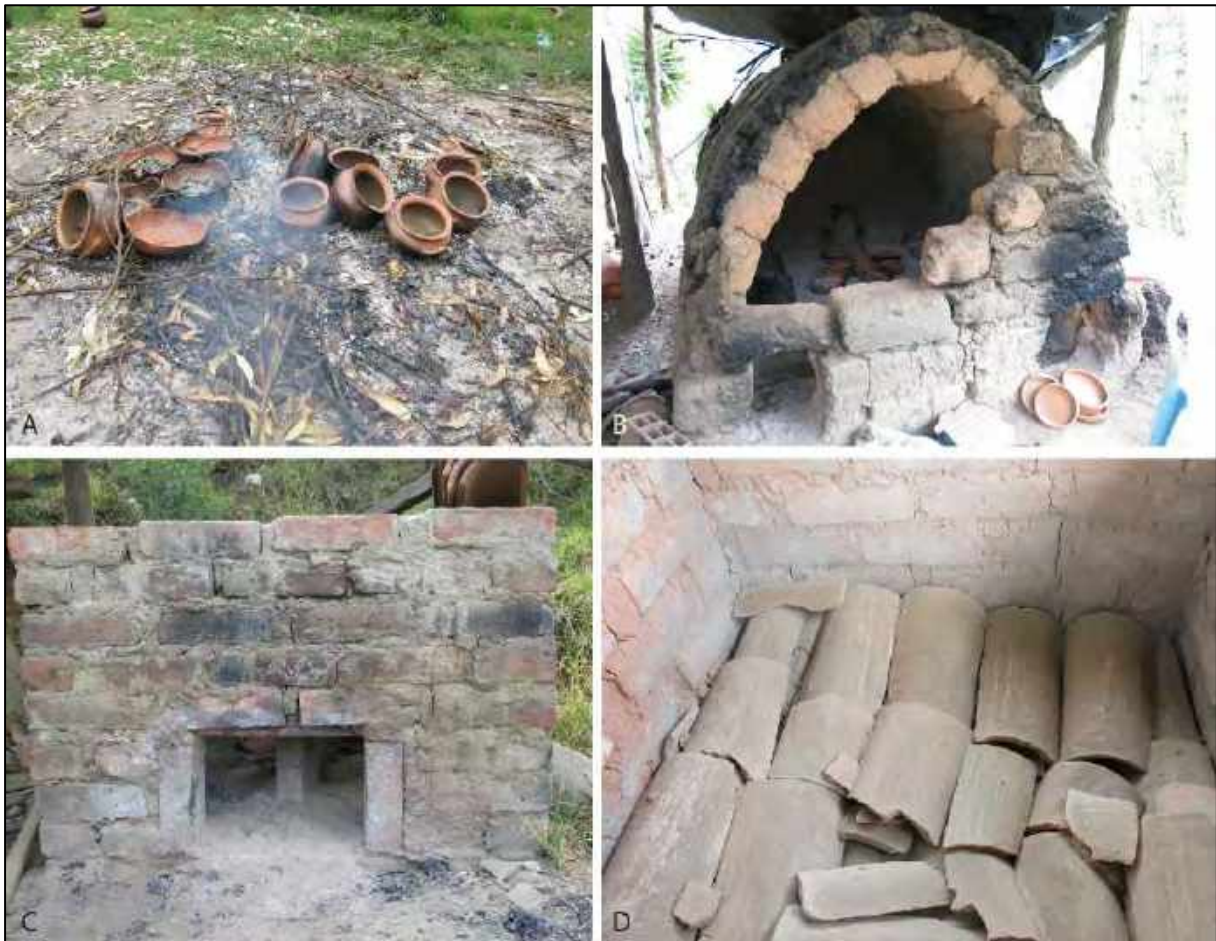
Fig. 4.45 : STRUCTURES DE CUISSON À TAQUIL. A : Pré-cuisson des pots. B : Structure de cuisson à enceinte. C : Four de Taquil (vue frontale). D : Four de Taquil (vu du dessus).
